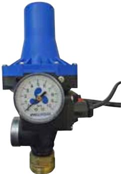
elektronischer Druckschalter, der die Pumpe druckabhängig einschaltet und strömungsabhängig ausschaltet sowie vor Trockenlauf schützt - Spannung 230 V/50 Hz, anschließbare, maximale Pumpenleistung 1,5 KW und 12 A, maximaler Durchfluss 6 m<sup>3</sup>/h und maximaler Wasserdruck 10 bar - verfügt über ein kleines Ausdehnungsgefäß, welches bei kleinen Leckagen vor zu häufigem Anlaufen und vor Druckschlägen schützt
